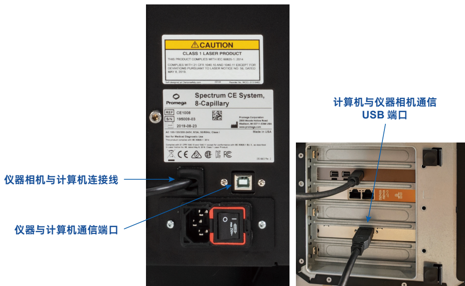
图 4 仪器相机与计算机连接线、仪器与计算机通信端口，计算机与仪器相机通信 USB 端口
